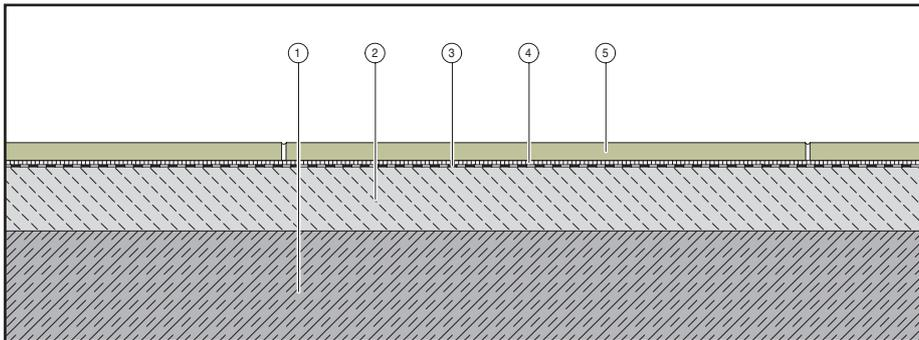
Gebundene Verlegung im Mörtelbett auf erdberührender Bodenplatte oder Betonkragplatte
