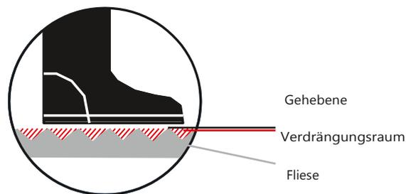
Der Verdrängungsraum ist der rot gekennzeichnete Hohlraum zwischen den Erhebungen der Fliese unterhalb der Gehebene.
